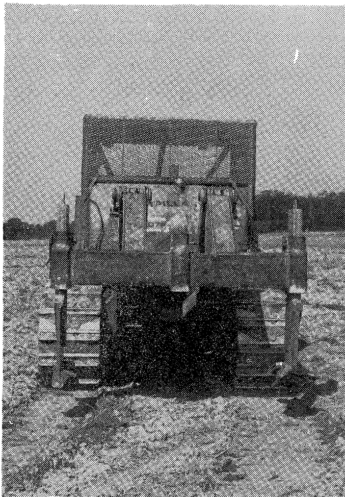
Slika 1. Podrivač s dva radna tijela
