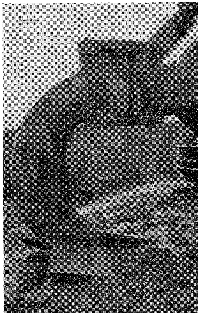
Slika 2. Podrivač za industrijsko podririvanje (dubina 70—90 cm)
